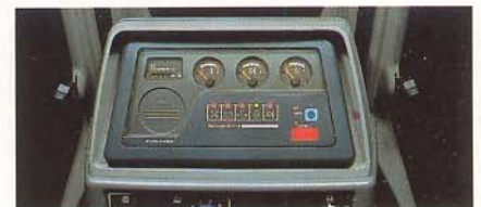
Elektronisches Anzeige- und Überwachungssystem
