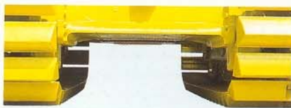
Halbschalenförmiger Hauptrahmen mit Flachbodenkonstruktion
