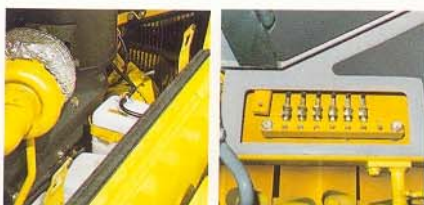
Ausgleichsbehälter am Kühler
