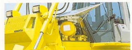
Weitöffnende Schwingtüren der Motorraumseitenverkleidung
